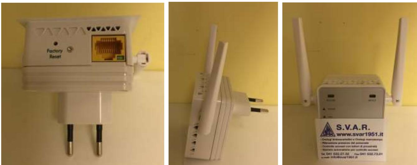
Questo adattatore Wi-Fi dovrà essere posizionato vicino al terminale di controllo accessi e connesso allo stesso tramite un cavo ethernet con connettore RJ45 e permetterà il collegamento del terminale alla vostra rete Wi-Fi.
