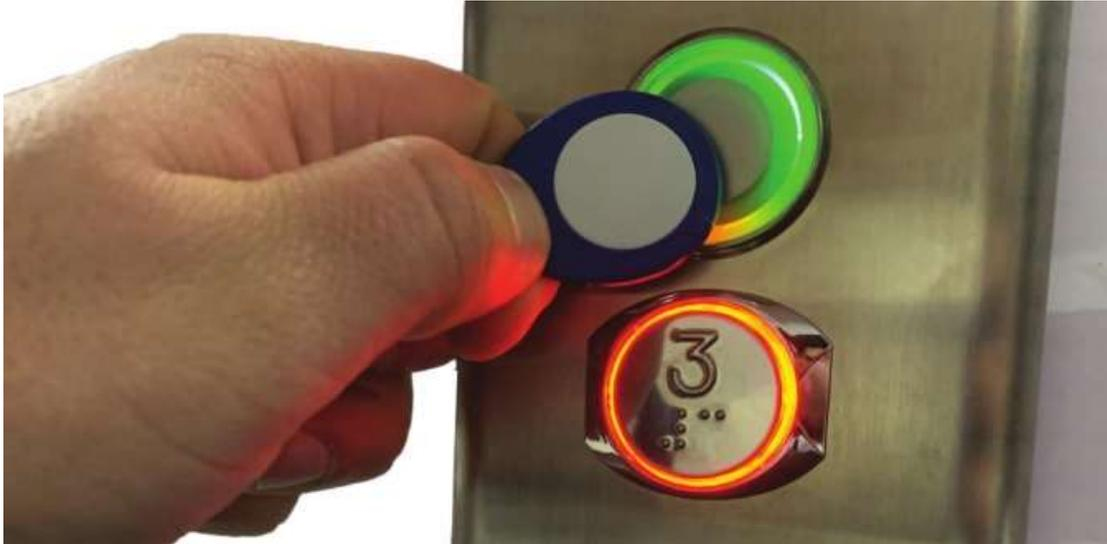
RFID-INCASSO è un terminale di controllo accessi che funziona con una alimentazione di 12/24 V DC per l'attivazione di pulsantiere con Tag di prossimità contactless RFID frequenza 125 KHz in formato tessera o ciondolo portachiavi. Il kit gestisce fino a 1.364 utenti, con Tag personali, abilitando pulsantiere di piano o di cabina. Il relè integrato è impostabile come bistabile o come monostabile, per un tempo compreso tra 0 e 255 secondi.
