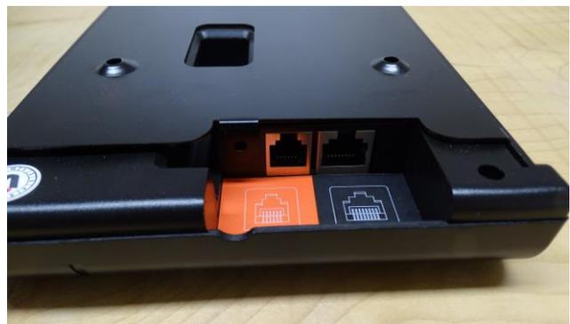
I dati (Utenti e Registrazioni) possono essere importati ed esportati tramite l'utilizzo di un collegamento LAN e l'uso di un Computer con installato il software di gestione.
