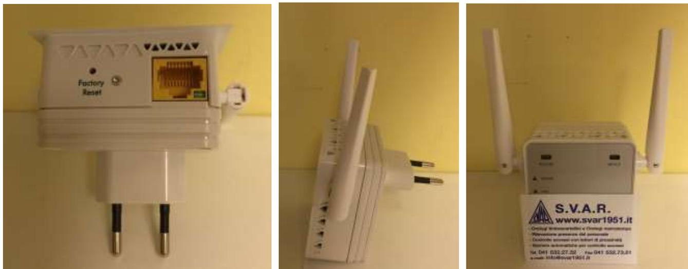
Questo adattatore Wi-Fi dovrà essere posizionato vicino al terminale di rilevazione presenze e connesso allo stesso tramite un cavo ethernet con connettore RJ45 e permetterà il collegamento del terminale alla vostra rete Wi-Fi.
